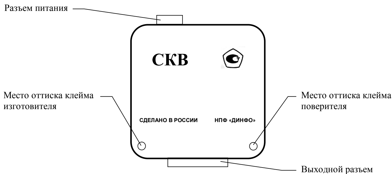
Рисунок 2 – Схема нанесения оттисков клейма на измерительный блок
